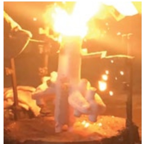
Actual pour of regenerative turbine pump cover at WPC.
